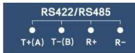
Figura 5 Definición de pines RS422/RS485
